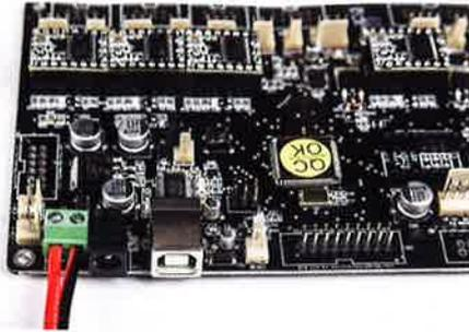
Figure 26a : câblage des fils de l'alimentation.
