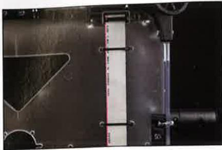
Figure 16 : ici le câble plat reliant la carte autonome à la carte contrôleur de l'imprimante. Le fil rouge se situe à gauche.
