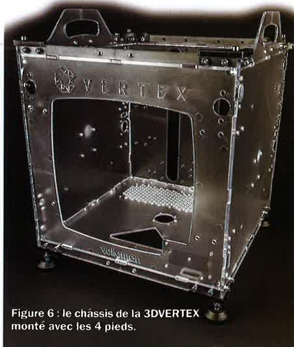
Figure 6 : le châssis de la 3DVERTEX monté avec les 4 pieds.
