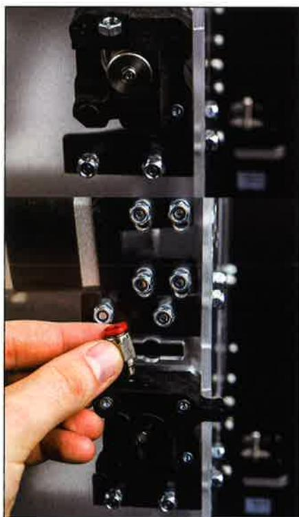
**Figure 25 :** montage de l'ensemble ressort + levier de desserrage. À droite vous pouvez voir le levier en place, il doit se manœuvrer sans effort.
