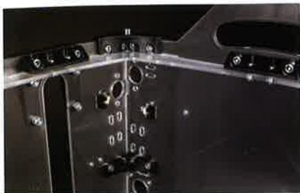
Figure 18 : montage des optocoupleurs de fin de course des axes X et Y sur les parois internes du châssis.
