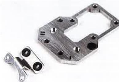
Figure 29d : disposition du support du petit ventilateur par rapport à la plaque de support de l'extrudeuse.
