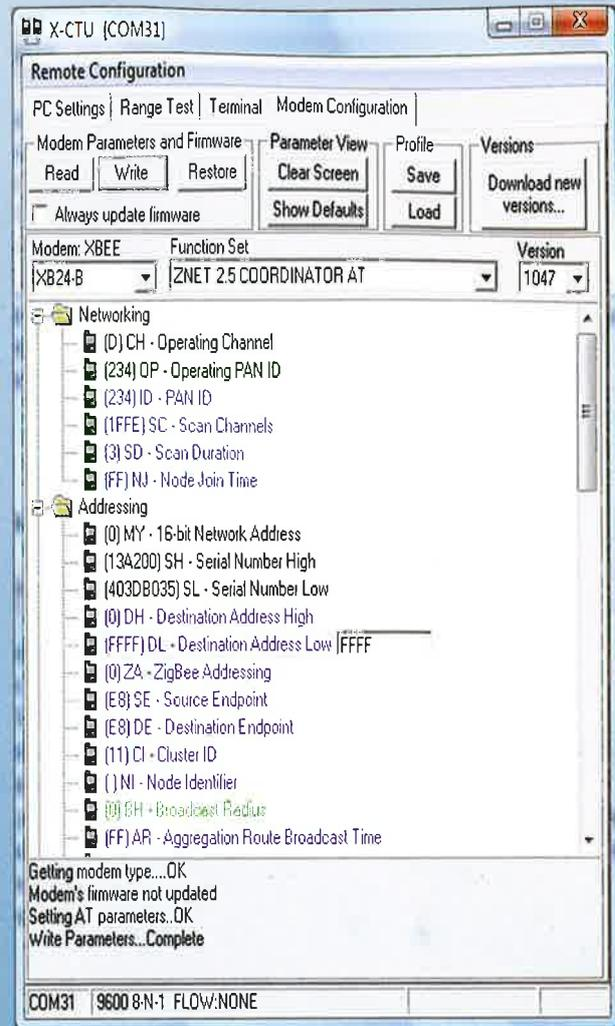
Figure 43 : configuration du paramètre « DL » du module « XBee » série 2.
