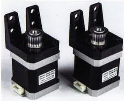
**Figure 20a :** orientation des moteurs des axes X et Y par rapport à leurs supports.
