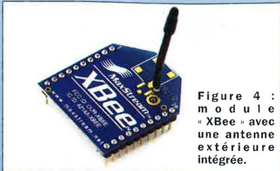
Figure 4 : module « XBee » avec une antenne extérieure intégrée.
