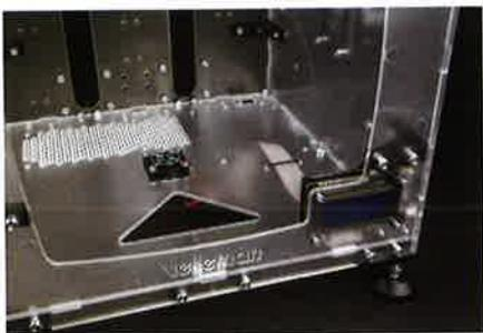
Figure 19 : montage du ventilateur inférieur sur le fond du châssis. Le flux d'air doit être dirigé vers le bas.
