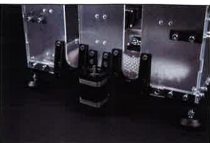
**Figure 22 :** montage du moteur de l'axe Z.
