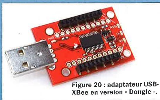
**Figure 20 :** adaptateur USB-XBee en version « Dongle ».
