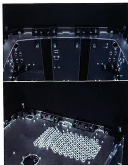
Figure 11 : chaque support des tiges de guidage du plateau d'impression est fixé à l'arrière à l'aide d'une petite équerre intérieur qui vient en butée contre la paroi arrière en polycarbonate.
