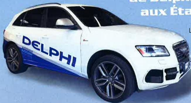
La voiture a été modifiée, des caméras spéciales, des radars et des logiciels ont été installés afin de tester tous les problèmes de la technologie « driverless » (sans conducteur). Pour des raisons de sécurité et afin de vérifier la fiabilité du SUV, un conducteur se trouve derrière le volant pour
