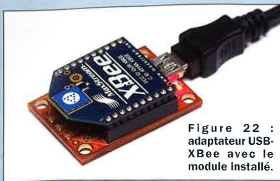
Figure 22 : adaptateur USB-XBee avec le module installé.
