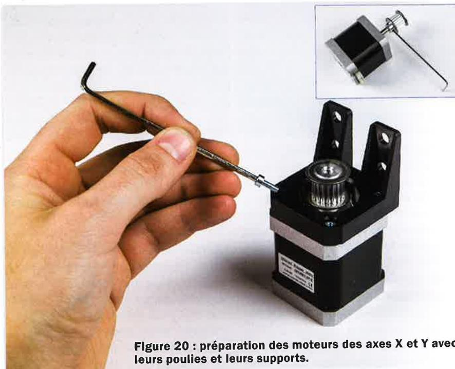
Figure 20 : préparation des moteurs des axes X et Y avec leurs poulies et leurs supports.
