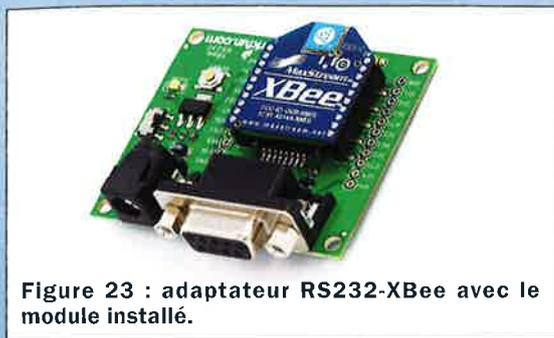
Figure 23 : adaptateur RS232-XBee avec le module installé.
