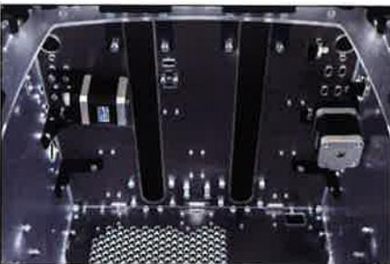
**Figure 21 :** positionnement des moteurs des axes X et Y dans le châssis.
