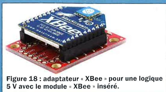
Figure 18 : adaptateur « XBee » pour une logique 5 V avec le module « XBee » inséré.
