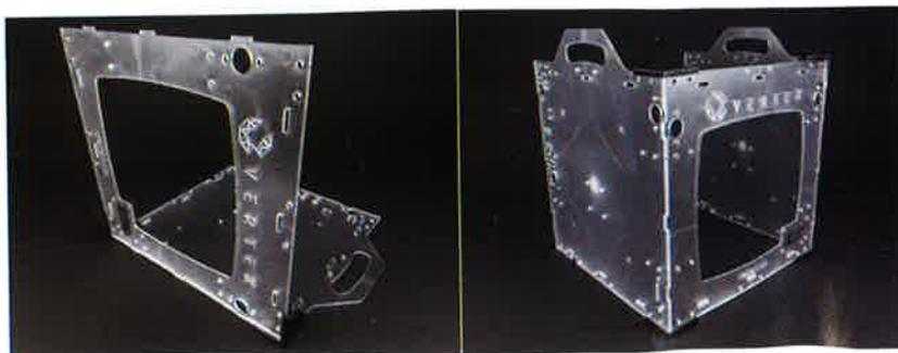
Figure 3 : assemblage des panneaux formant le châssis de la 3DVERTEX.
