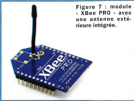
Figure 7 : module « XBee PRO » avec une antenne extérieure intégrée.
