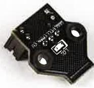
Figure 17 : montage de l'optocoupleur de fin de course de l'axe Z avec les rondelles isolantes.
