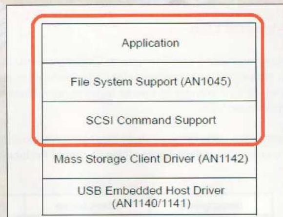
Figure 6 : architecture d'une application hôte prenant en charge la classe USB MSD.
