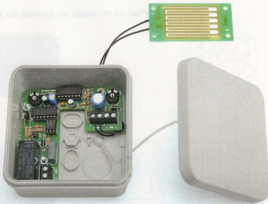
Une chute de tension croissante apparaît entre les armatures de C2, si bien que sa broche négative fait chuter la tension présente sur les entrées de « U1d » (les entrées se rapprochent de plus en plus d'un niveau 0) dans un temps environ égal au produit de la somme des résistances et de sa valeur capacitive.
