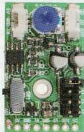
Photo de l'un de nos prototypes de la breakout board NE555.
