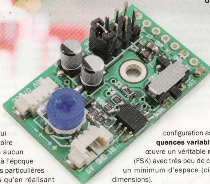
L'un des circuits intégrés qui ont contribué à forger l'histoire de l'électronique est sans aucun doute le **NE555**, car il permettait à l'époque d'implémenter plusieurs fonctions particulières qui ne pouvaient être obtenues qu'en réalisant un circuit spécifique (pour chaque fonction) avec des composants discrets.
