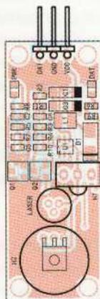
Plan de câblage des composants de la barrière laser.
