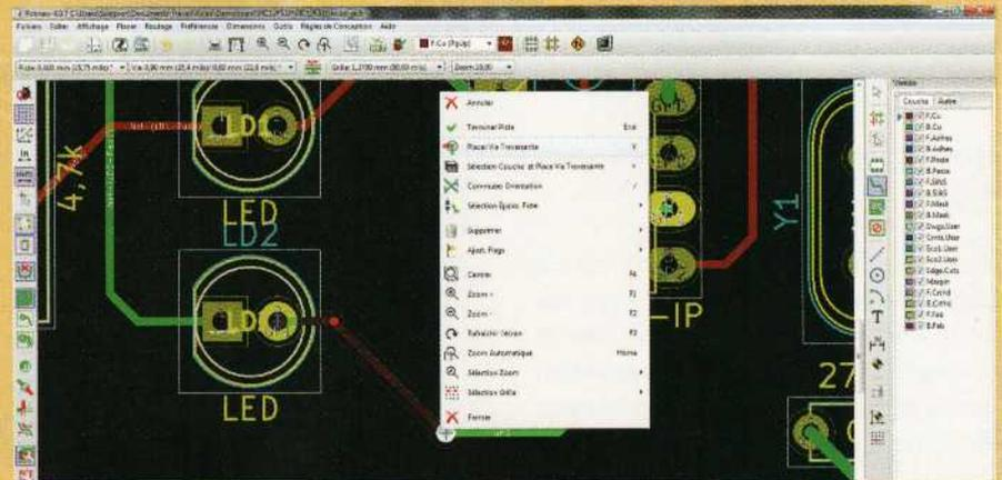
Figure 19 : Insertion d'un via pour l'interconnexion entre les deux couches.
