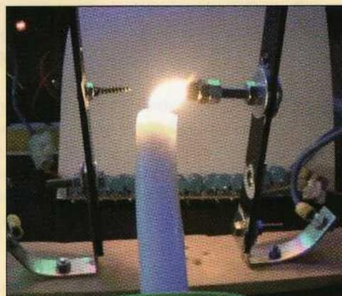
Figure 8 : Effet du vent ionique sur la flamme.
