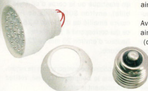
La lampe que nous avons utilisée est de type LED. À côté vous la voyez démontée. Nous avons récupéré le globe et la partie inférieure du culot.
