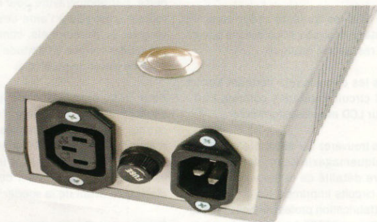
Nous avons utilisé, pour la prise secteur et celle de la charge, des embases mâles/femelles pour châssis. Vous pouvez utiliser d'autres types de prises.
