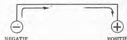
Fig. 10 - Le mouvement des électrons (courant) entre deux corps électriquement chargés et reliés par un conducteur, se poursuit tant que persiste la force qui l'a produit, c'est-à-dire la « force électromotrice » ou « tension »; il cesse quand les deux charges sont équilibrées.
