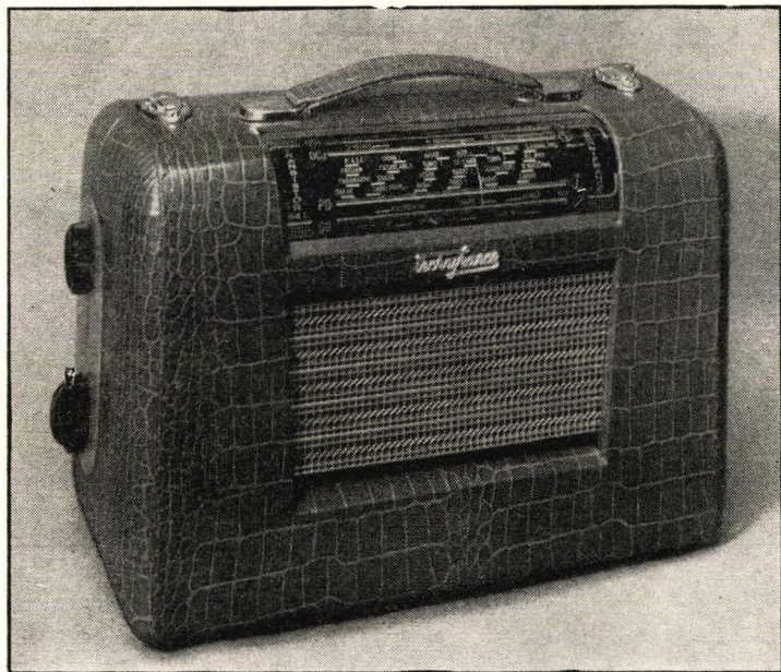
Aspect extérieur du récepteur « Transistor 8 », l'antenne télescopique, que l'on devine à droite, derrière la fermeture, étant repliée.
