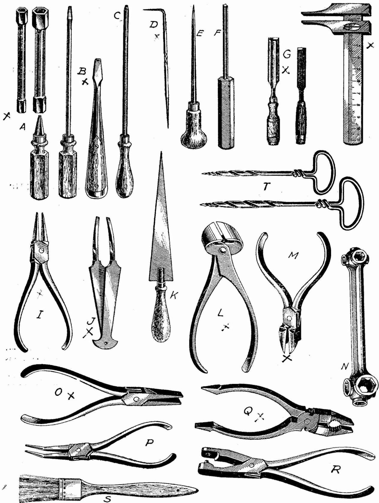
A. Clef à tubes interchangeables — B. Tournevis — C. Tournevis pour trimmers et paddings, manche et tige isolants — D. Tire-ligne — E. Poinçon — F. Tamponnoir — G. Ciseaux à bois — H. Pied à coulisse — I. Pince ronde (2 jeux) — J. Précelle — K. Alésoir — L. Pince coupante droite — M. Pince coupante perroquet — N. Clef multiple — O. Pince plate (2 jeux) — P. Pince ronde coudée et longue — Q. Pince universelle — R. Perforeuse, riveteuse — S. Pinceau queue de morue — T. Vrilles à bois.
