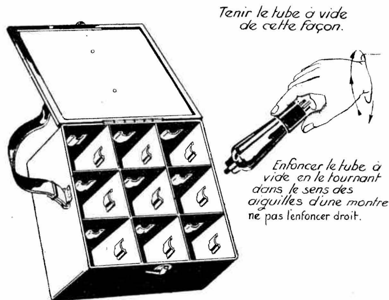
FIG.13_MISE EN PLACE DES TUBES A VIDE DANS LA BOITE DE TUBES A VIDE ET VIBREURS DE RECHANGE
