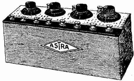
Ensemble d'un filtre et de 3 étages MF à condensateur à air. Blindage absolu.
