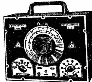
Oscillateur. HAUTE FREQUENCE EN MONTAGE " Feed Back " de 100 kcs à 30 mcs sans trous (3.000 m. à 10 m.), modulé à 400 périodes par la plaque.
