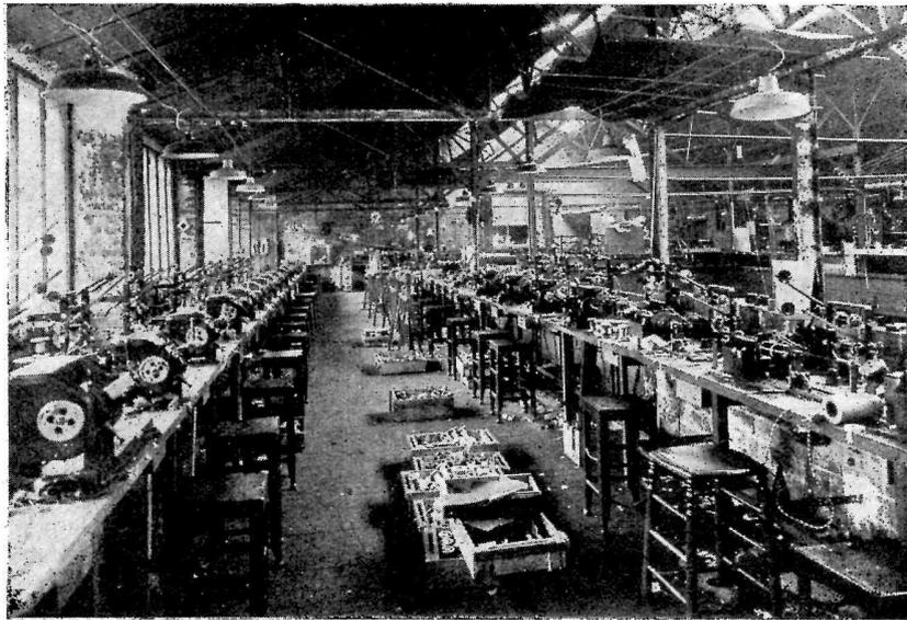
La construction en série des transformateurs d'alimentation dans une usine moderne : bobinage. (Cliché Vedovelli.)
