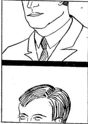
FIG. 26. — Comment l'image peut apparaître par suite de synchronisme et d'isochronisme imparfaits. Au milieu la bande noire de synchronisation.
