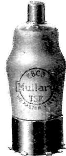
Le tube E B C 3 comprend les éléments d'un double diode et d'un tube triode spécialement prévu pour l'amplification des courants téléphoniques.
