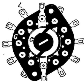
Fig. 5. — Détail d'un élément du contacteur rotatif Giress .
