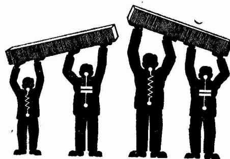
Fig. 6. — Une même capacité, à la même fréquence, supporte tout le débit de courant alternatif ou, au contraire, un débit très faible, suivant que la résistance en parallèle est grande ou petite. C'est ce que vous enseignent ces déménageurs.
