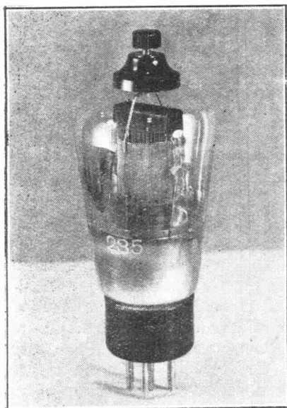
Pentode H. F. ; modèle de laboratoire.
