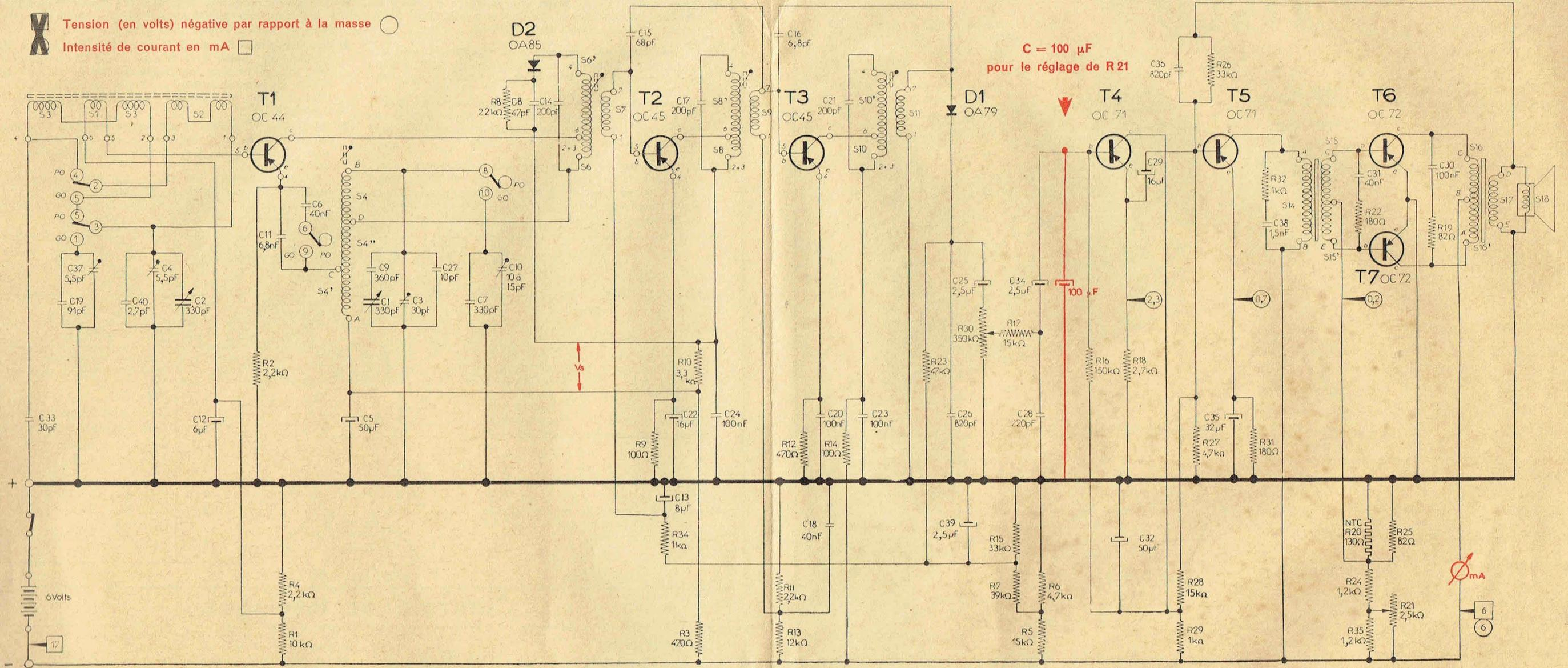
Les transistors utilisés dans cet appareil sont du type PNP. Le montage est dit : émetteur à la masse; la ligne haute tension est donc négative.
