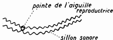
Fig. 2. — La pointe de l'aiguille reproductrice ne peut suivre les courbes trop resserrées du sillon de faible amplitude
