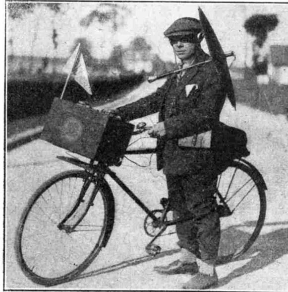
Fig 5. — La T. S. F. en bicyclette. Le poste récepteur est placé sur le guidon, et le cadre est contenu dans une ombrelle.
