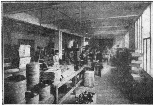
Fig. 16. — Vérification et polissage des disques terminés (Usine Odéon).
