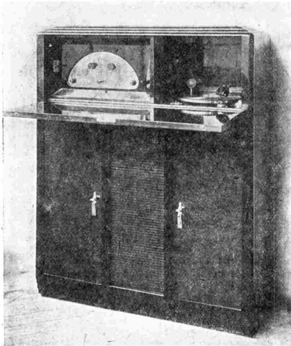
Fig. 2. — Poste-meuble Radio-L.L. radiophonique et phonographique. A gauche, l'appareil de réception radiophonique à réglage essentiel unique et à changement de fréquence. A droite, le phonographe électrique avec pick-up adapté au moyen d'un jack avec fiche aux étages basse fréquence du poste récepteur.
