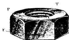
Écrou à six pans. — F, pans de l'écrou hexagonal. — P, tête plate de l'écrou. — T, taraudage intérieur.
