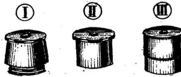
*Bouchons d'aération pour accumulateurs*. — Types de bouchons pour l'aération des accumulateurs, les deux premiers en celluloid, se vissant sur les bacs; le troisième en caoutchouc, percés tous trois d'un trou central pour l'échappement des gaz pendant la charge.
