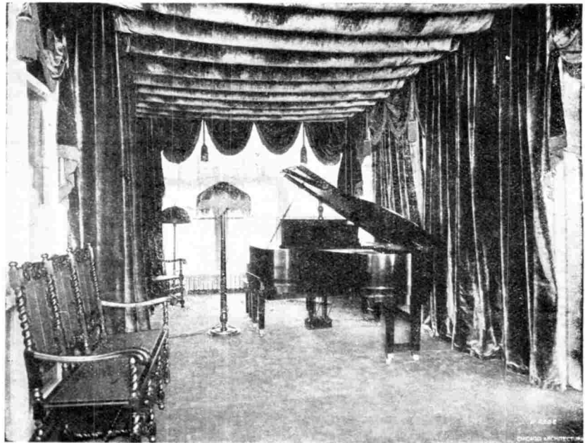
Fig. 18. — Le «studio» d'une station de téléphonie sans fil. C'est la pièce où les chanteurs et musiciens exécutent les morceaux à transmettre. Ses propriétés acoustiques ont été soigneusement étudiées : elle ne doit présenter aucun écho, ce qui est obtenu en recouvrant les murs et le plafond de draperies absorbantes ; le parquet est généralement couvert d'un épais tapis. Le microphone, dont la présence impressionne étrangement certains artistes, est ici dissimulé sous l'abat-jour de la lampe que l'on voit à gauche du piano.
