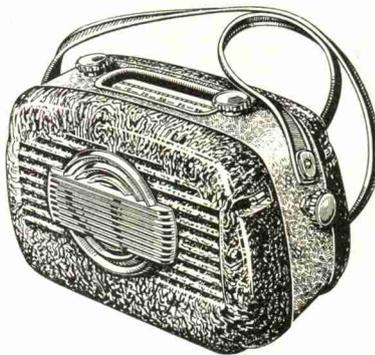
Comporte 6 lampes : 1T4, 1R5, 1T4, 1S5, 3Q4, et 117Z3. Grande sensibilité par étage amplificateur haute fréquence aperiodique précédant le changement de fréquence — réception sur antenne incorporée dans la bandoulière — 3 gammes d'ondes normales — haut-parleur AUDAX
