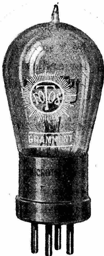
Fig. 77. — Lampe Microtriode à faible consommation (Cl. Péricaud).
