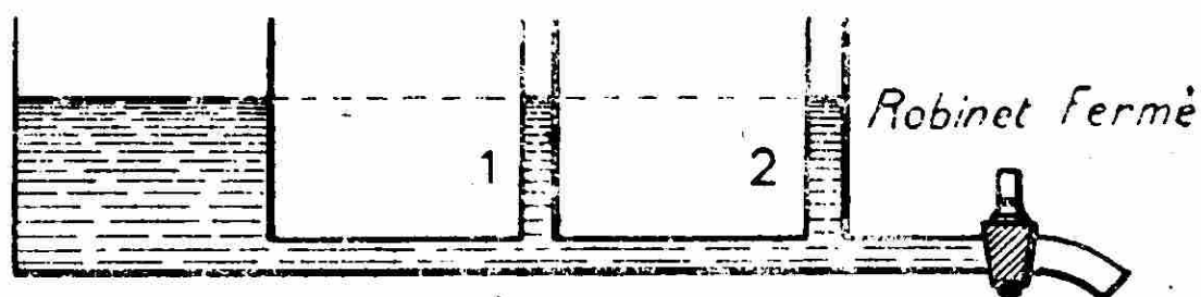
Fig. 43. — Expérience des vases communicants : l'eau est la même hauteur dans les tubes 1 et 2, le robinet étant fermé.
