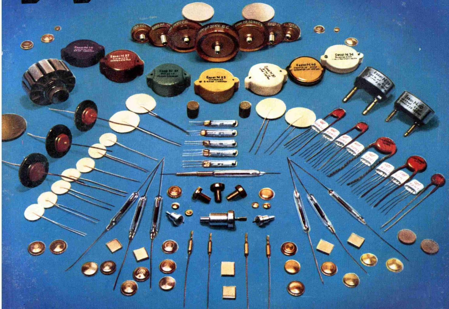
Pièces détachées spéciales (triodes germanium à jonction PNP, redresseurs de puissance au germanium, phototransistors, résistances aux linéaires, pseudo-alliages pour contacts, etc.), étudiées par le Département de Recherches Physico-Chimiques de la COMPAGNIE GÉNÉRALE DE TÉLÉGRAPHIE SANS FIL.
