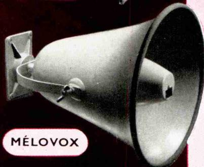
**105 T. INV.** : Champ réel en gauss : 8.000. Impédance de la bobine mobile : 4,2 ohms à 800 p.p.s. Puissance modulée de crête : 1,5 watt. Fréquence de résonance : 200 p.p.s. Diamètre extérieur : 104 mm. Poids : 200 gr.
