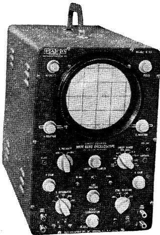
**Ampli vertical :** 3 étages symétriques - Alternatif : sensibilité 1 mV par mm. Bande passante - 3 db à 1 Hz à 4,5 Mhz - Continu : sensibilité 2,8 mV par mm. Bande passante C (continu) à 4,5 Mhz à -3 db - Temps de montée meilleur que 0,08 us - Impédance d'entrée 1,5 Mg + 23 pf - Atténuateur 4 positions compensé - Commutateur inversion de polarité.
