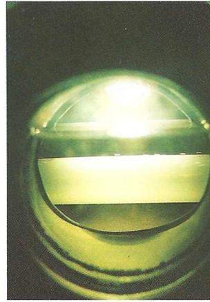
Refroidissement de l'isolant après extrusion.
