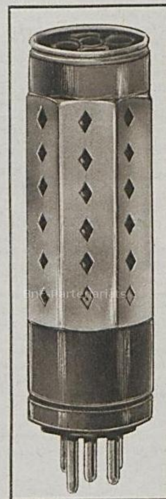
FIG. 3. — VUE EXTERIEURE DE LA NOUVELLE LAMPE COUVERTE PAR LE BLINDAGE PROTECTEUR. Ces dimensions sont exactement celles de la lampe de T. S. F. ordinaire.
