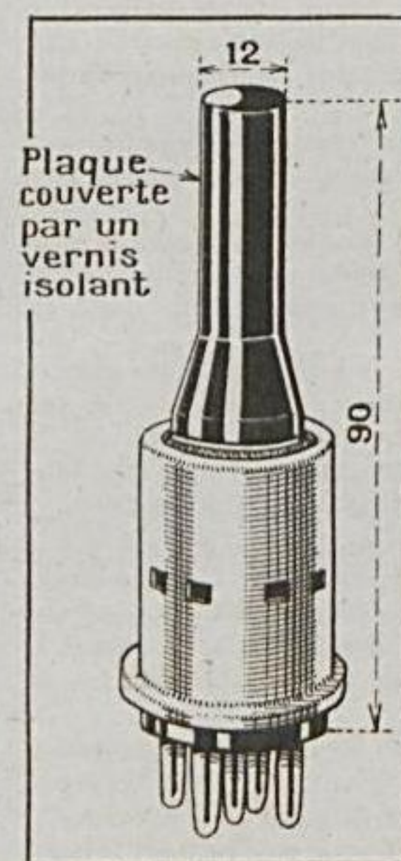
FIG. 2. — ASPECT DE LA LAMPE CATKIN SANS SON BLINDAGE DE PROTECTION.
