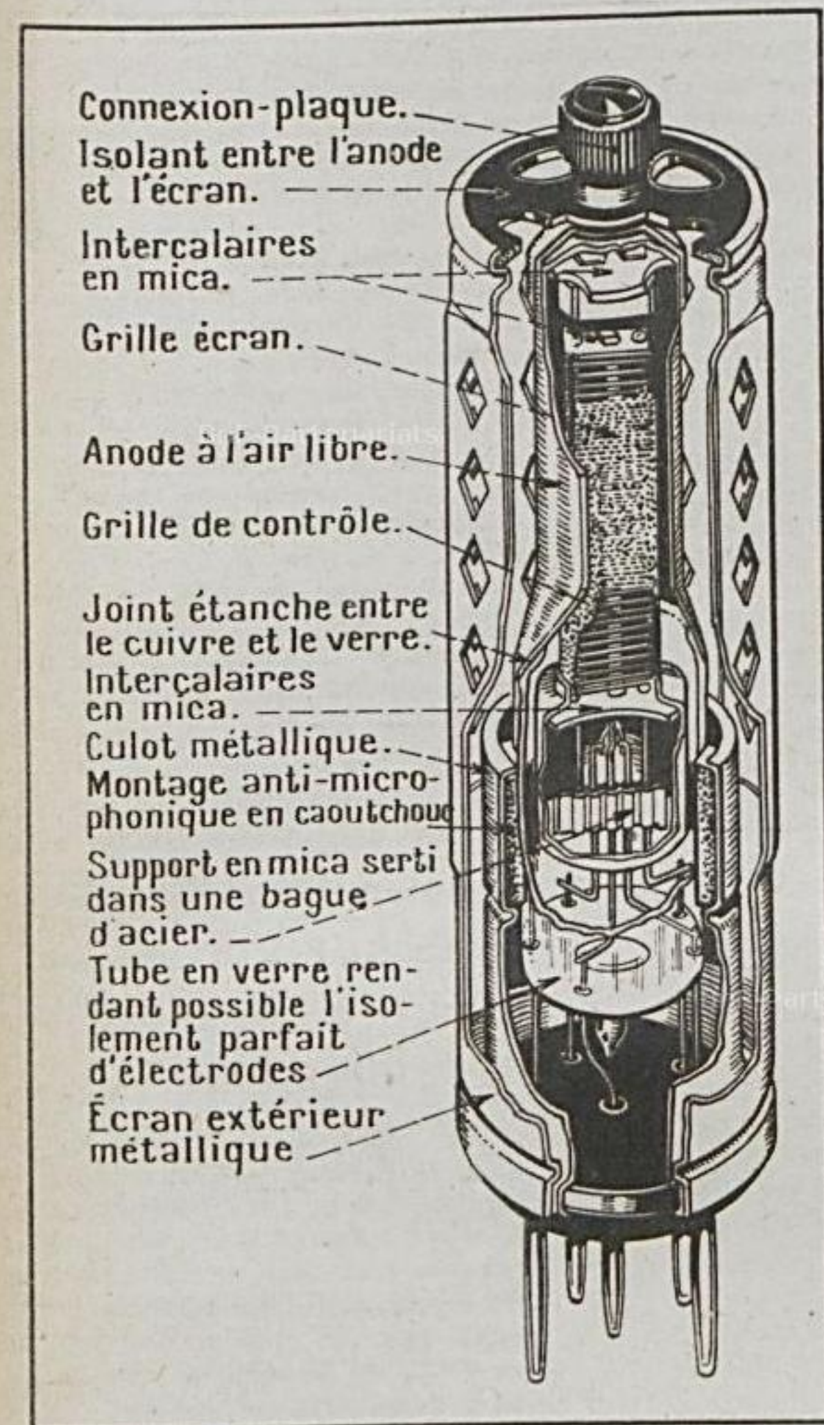
FIG. 1. — CONSTRUCTION INTÉRIEURE DE LA LAMPE CATKIN.
