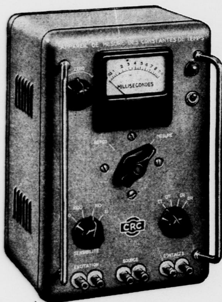
FIG. 1. — Appareil de mesures des constantes de temps. — Chronoscope électronique vue d'ensemble.
