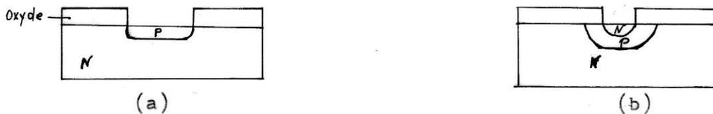
L'opération est renouvelée à l'aide d'un deuxième masque d'oxyde délimitant une surface plus petite pour l'émetteur (fig. b).
