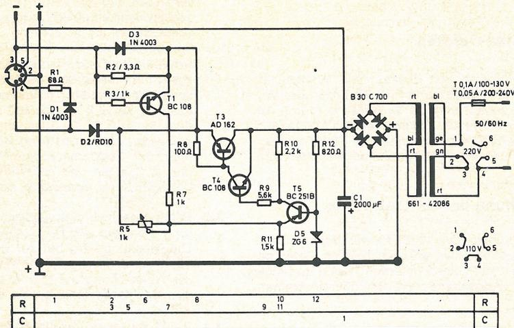
**UHER** Netzanschluß- und Ladegerät Z124A
