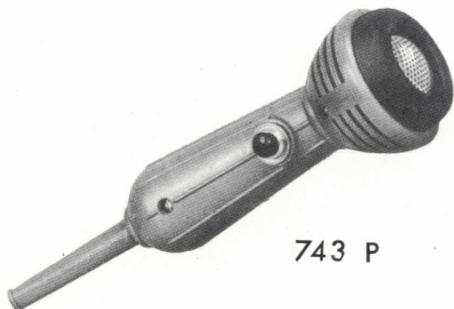
**743 P** Microphone électro-dynamique à main, anti-Larsen (différentiel) convient pour la reproduction de la parole (500 à 6.000 Hz), bouton poussoir - 3 m. câble, connecteur 4 broches. Résiste bien aux intempéries et aux chocs.
