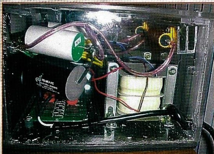
Fig. 16 Au fond du coffret, le multiplicateur de tension électronique.
