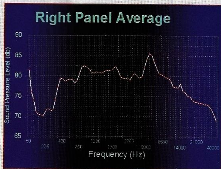
Fig. 20 Courbe de réponse du panneau électrostatique (voie droite) relevée par Mathew Anker selon le protocole de test décrit.
