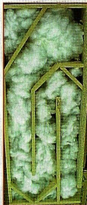
Fig.22 La totalité de l'évent est rembourrée de polyfill afin de constituer un filtre passe bas acoustique très efficace.
