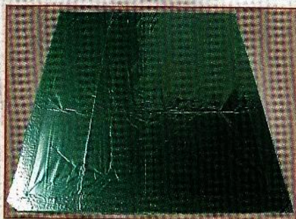
Fig. 9 Le film de mylar est tendu sur le cadre intercalaire. Les plis sont à faire disparaître avec un sèche-cheveux passé à une distance de 5 à 10 cm.
