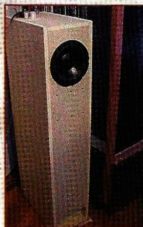
Fig.23 L'enceinte équipée de son woofer de 21 cm. L'évent débouche au bas du panneau avant.
