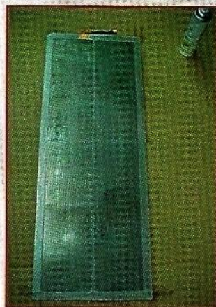
Fig.5 Le diaphragme doté de sa connexion électrique.
