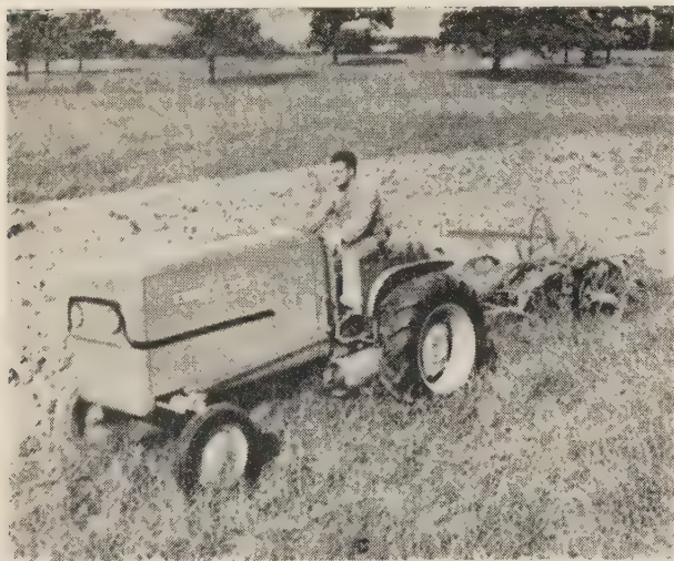
FIG. 1. — Modèle expérimental de tracteur mû à l'aide de piles à combustible. Document aimablement communiqué par Allis Chalmers.
