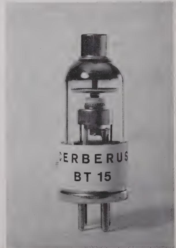
Tube électronique à cathode froide type arcotron pour 220 volts CA et 3 A pour la commande de puissance jusqu'à 500 watts.
