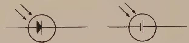
Cellule photo conductive à conductibilité asymétrique.
