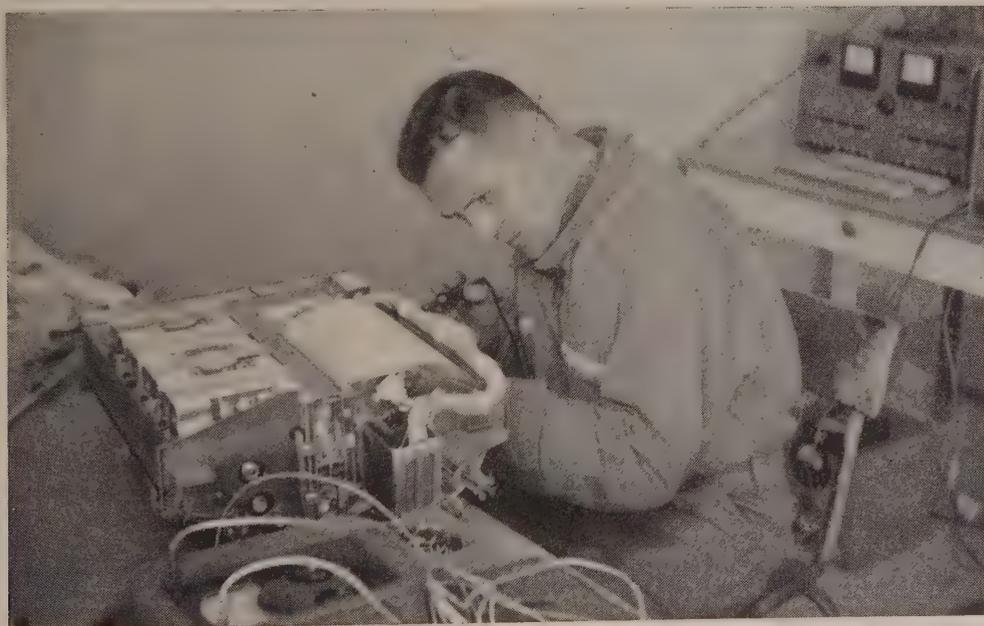
FIG. 3. — Le répondeur-radar et la télémessure sont prêts, ils sont montés sur un tiroir autonome qui comporte également les diverses alimentations de bord et les relais de commutation.
