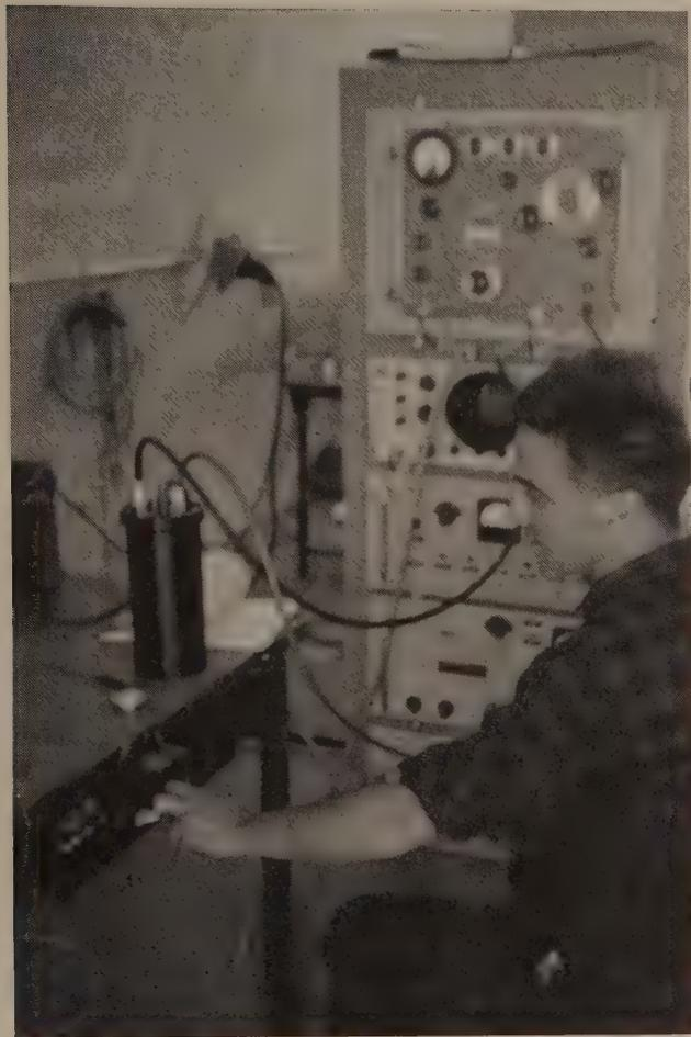
FIG. 2. — Le répondeur-radar comme l'émetteur de télémessure est vérifié à l'aide d'un ensemble de contrôle spécialisé.
