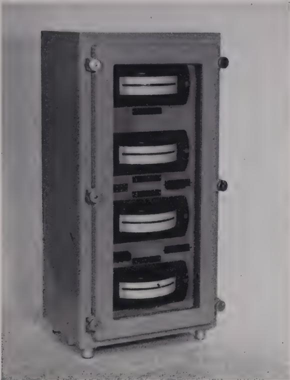
FIG. 9. — Armoire des organes individuels émetteurs de télémesures : vue extérieure.
