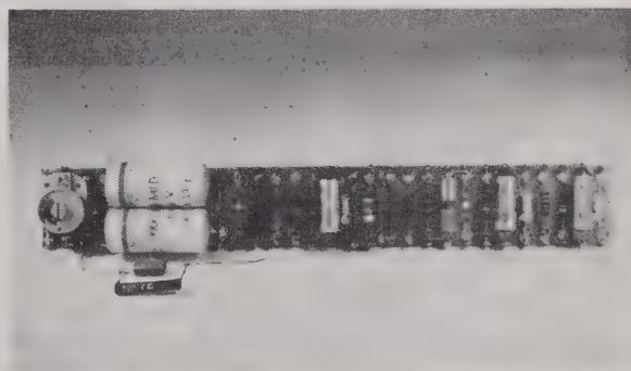
FIG. 21. — Une réalisation du montage à transistors.
