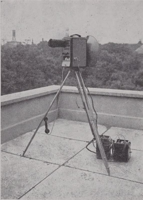
FIG. 1. — Telluromètre. (Photo Institut Géographique National)
