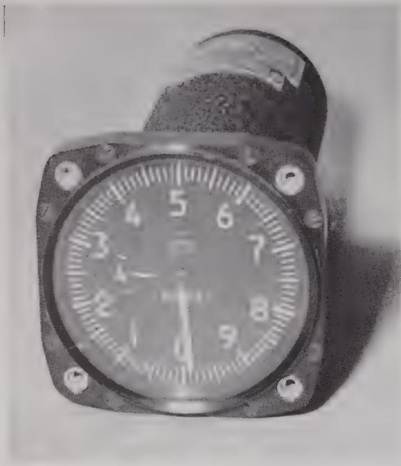
FIG. 6. — Indicateur du radioaltimètre THC 995. Module 80 (Norme BNAé 400.01.1). L'indicateur peut aussi être réalisé dans des dimensions plus réduites (Module 57).
