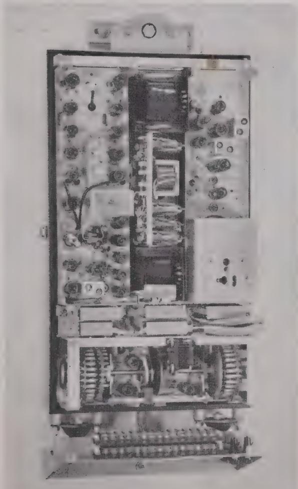
FIG. 3. — Coffret émetteur-récepteur. Capot déposé. A la partie supérieure, de gauche à droite, sont disposées les platines de réception, d'alimentation et d'émission. A la partie inférieure se trouve le bloc des quartz.
