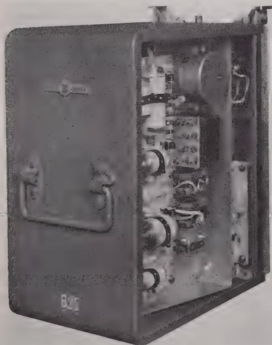
FIG. 11. — Appareillage G.E.S.E. : vue d'ensemble d'un bloc émetteur-récepteur.
