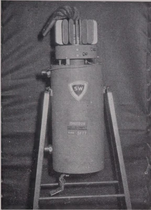
FIG. 1. — Ignitron d'une locomotive électrique à courant monophasé 50 Hz.
