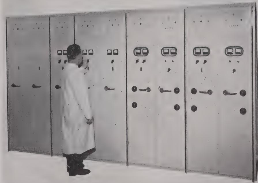
FIG. 13. — Equipement « en diversité quadruple ».
