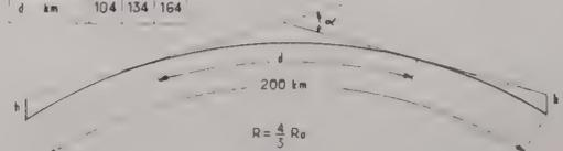
FIG. 1. — Profil type d'une liaison au-delà de l'horizon.
