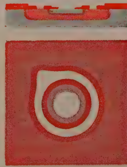
6 - Les surfaces de contact de base et d'émetteur sont nettoyées de l'oxyde.
