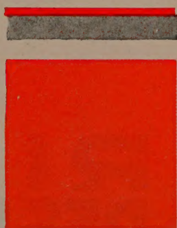
1 - La pastille de silicium toute entière reçoit une couche d'oxyde protecteur.
