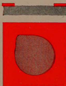
2 - A l'aide d'un masque, l'oxyde est enlevé pour créer une fenêtre.
