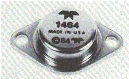
Le 1464 est présenté dans un boîtier TO-3 8 broches. Le modèle standard est prévu pour fonctionner sur une plage de température de  $-55$  °C à  $+125$  °C. Un blindage spécial existe pour applications militaires/aérospatiales.
