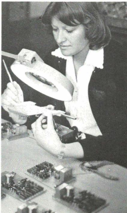
La loupe de la lampe a un diamètre de 120 mm et un grossissement de quatre dioptries ; elle peut être complétée par une lentille fixée par mastic d'un diamètre de 30 mm avec 10 dioptries. Le déploiement est de 800 mm.
