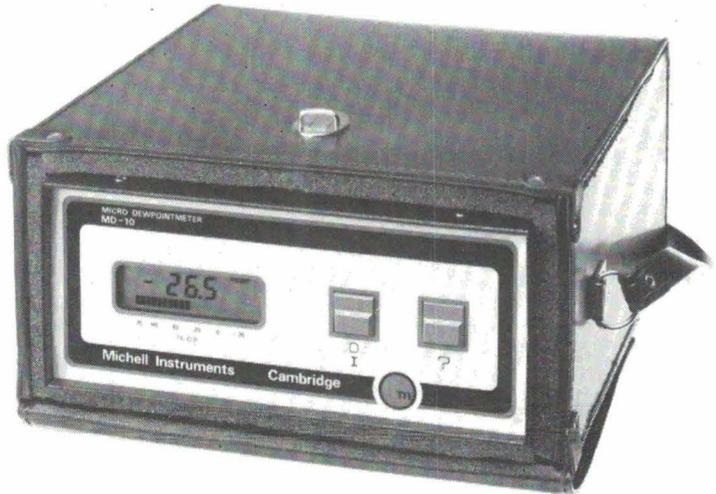
ppm (poids) pour cinq gaz courants : air, hydrogène, gaz carbonique, azote et gaz naturel. Avec un affichage numérique à cristaux liquides et une barre analogique, l'instrument com-
