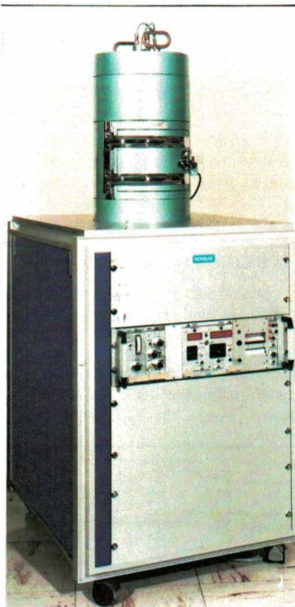
Fig. 31. - Analyses quantitative et qualitative d'émetteurs dans divers échantillons-scintillateur NaI (doc. Novelec).
