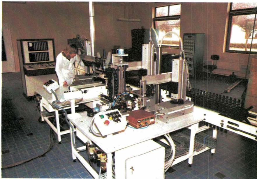
Chaîne d'assemblage robotisée, commandée par un automate programmable.
