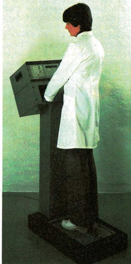
Fig. 24. - Moniteur de surveillance de la contamination des mains et des pieds. Les détecteurs sont des compteurs proportionnels remplis de xénon (doc. Berthold).
