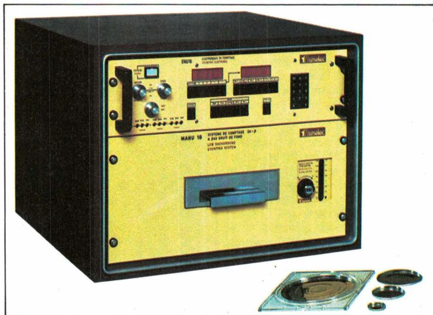
Fig. 27. – Cellule manuelle de comptage faible activité  $\alpha$  et  $\beta$  MANU 16 de Numelec.
