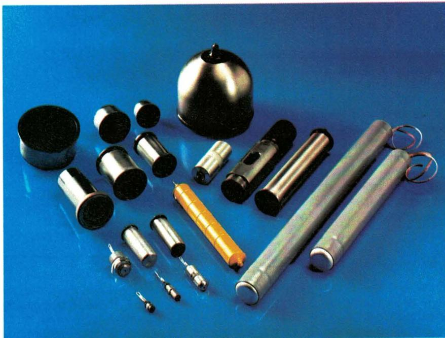
Fig. 28. – Différents modèles de compteurs Geiger-Müller (doc. RTC).
