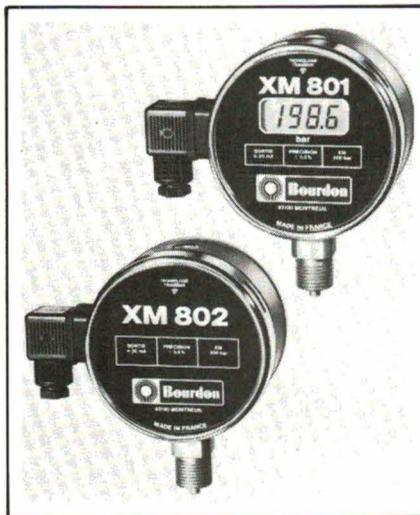
Transmetteurs de pression : ils associent le capteur Transbar et une électronique intégrée qui transforme la déformation des jauges sérigraphiées en un courant directement proportionnel à la pression. Leur précision est de 0,5 % de l'étendue de mesure (cliché : Bourdon).
