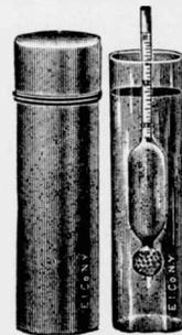
Fig. 1. A Hydrometer
