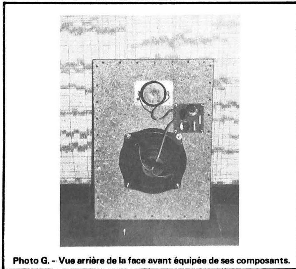
Photo G. - Vue arrière de la face avant équipée de ses composants.
