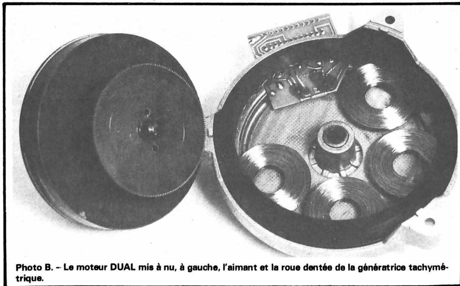
Photo B. - Le moteur DUAL mis à nu, à gauche, l'aimant et la roue dentée de la génératrice tachymétrique.
