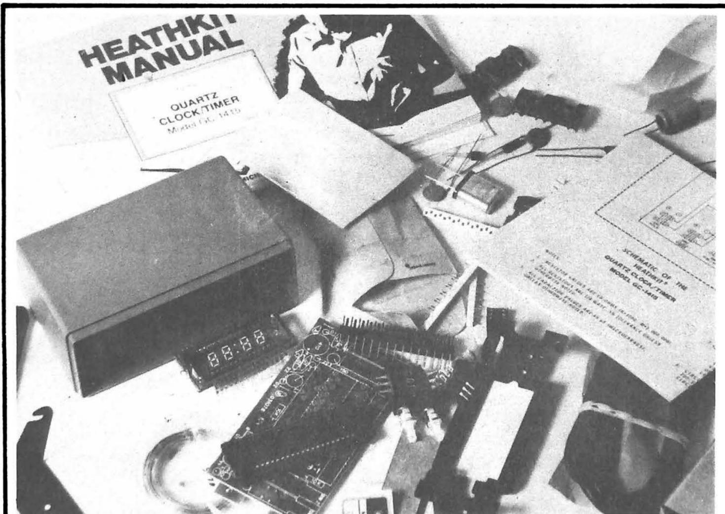
Photo B. - Les composants pêle-mêle avant la vérification. On reconnaît ici l'afficheur, les circuits intégrés et imprimés.
