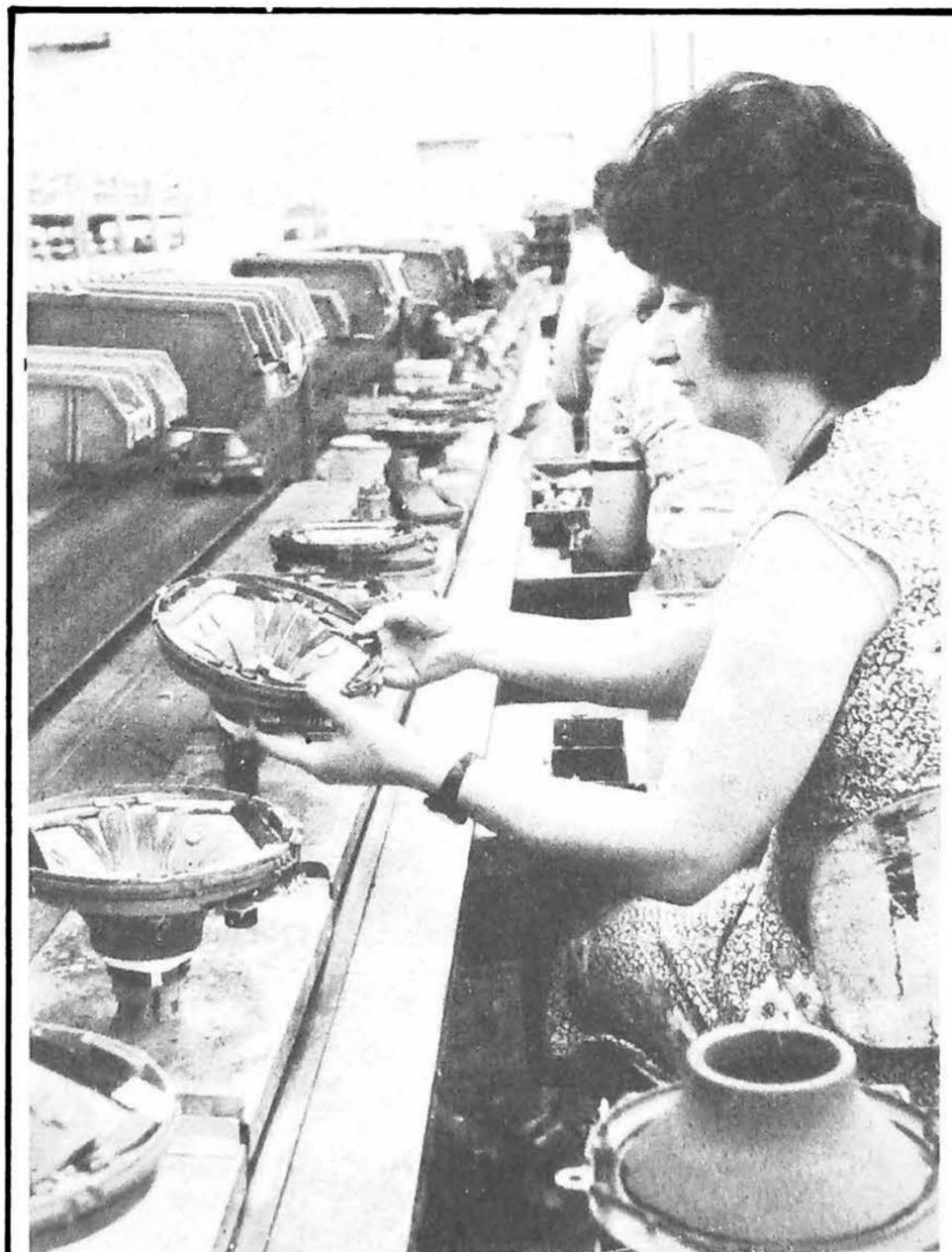
Photo 1. - Fabrication des bobines de déviation dans l'usine de Hanovre.
