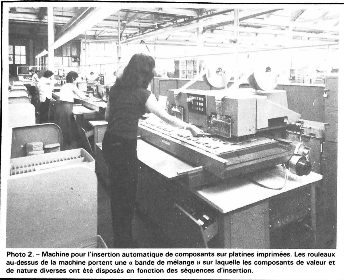
Photo 2. - Machine pour l'insertion automatique de composants sur platines imprimées. Les rouleaux au-dessus de la machine portent une « bande de mélange » sur laquelle les composants de valeur et de nature diverses ont été disposés en fonction des séquences d'insertion.
