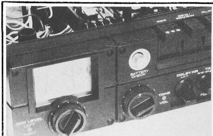
Photo B. - Un double vu-mètre, des boutons garnis de caoutchouc, le confort de manipulation est assuré. Toutes les commandes sont frontales mais le compteur demeure invisible.
