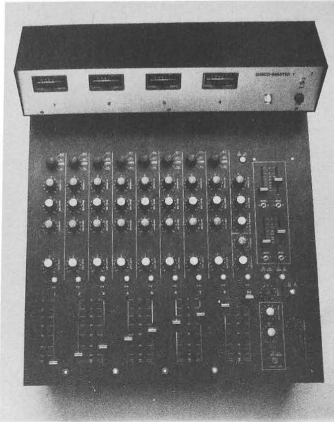
platines tourne-disques stéréo, quatre magnétophones Stéréo et 8 micros. Les sorties peuvent diffuser en stéréo sur deux pistes de danse ou diffuser en stéréo sur une piste de danse avec deux départs mono (pour le bar et les tables par exemple).
